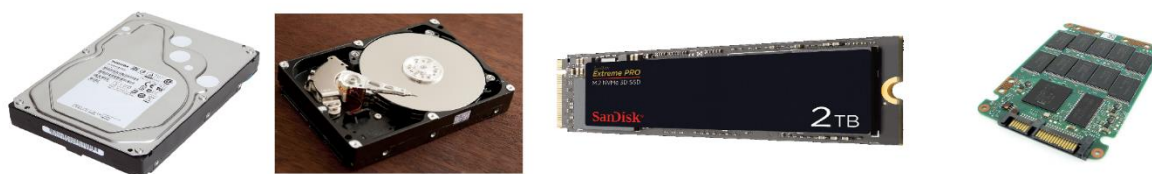
Рис 1.7. Жорсткий диск (HDD, зліва) та Тверdotілий диск (SSD, справа)
