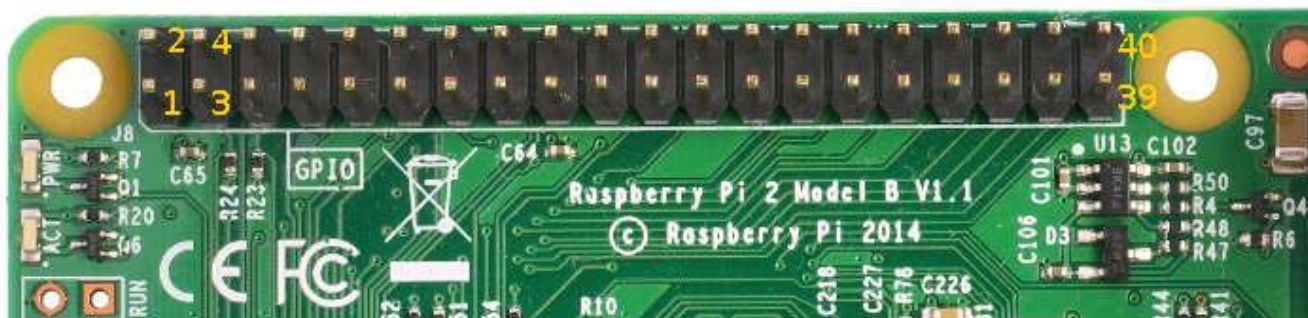
Рис 2.1 Зовнішній вигляд роз'єму портів вводу-виводу загального призначення GPIO (General-purpose input/output) із нумерацією виводів
