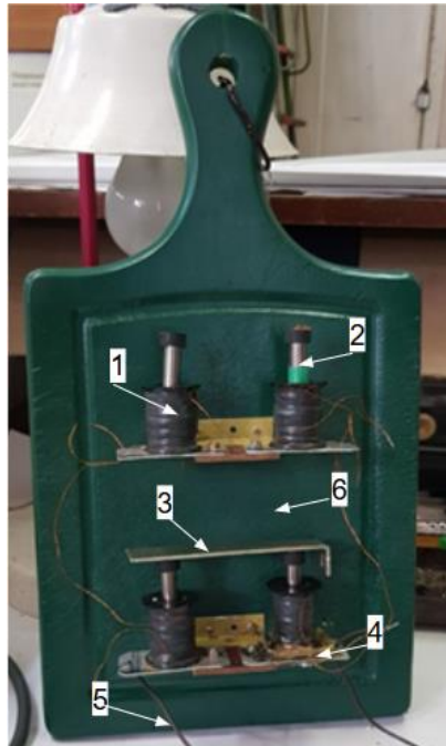
Рис. 2.3 Установка (основні складові пристрою: 1. чотири електромагнітні котушки з мідною обмоткою; 2. Стержні з закріпленими на них магнітами; 3. Магніт ззовні котушки; 4. Куточки для підтримки котушок; 5. Діодний місток; 6. Рама на якій закріплені котушки)
