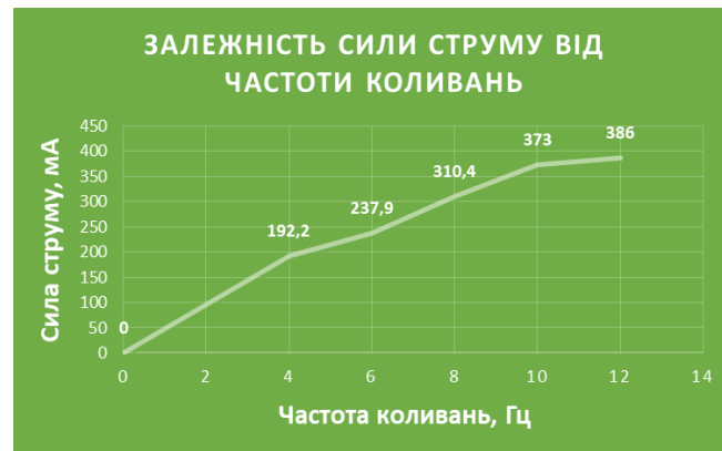
Рис. 2.5 Графік залежності сили струму від частоти коливань
