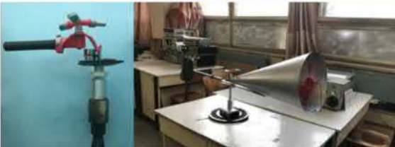
Рис. 1. Макет вітряного генератора використаний в експериментах
