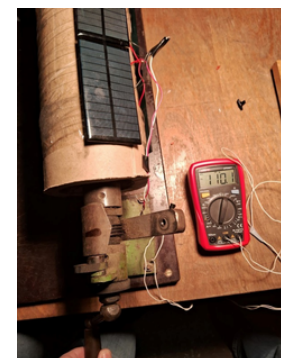
Рис. 5. Сила струму під час обертання
