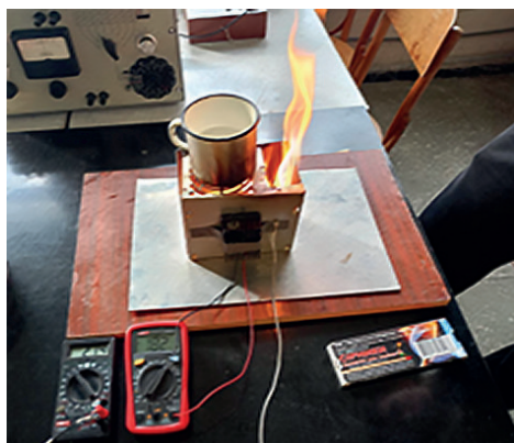
Фото 1 – Зображення прототипу термогенератора “Мініпіч”
